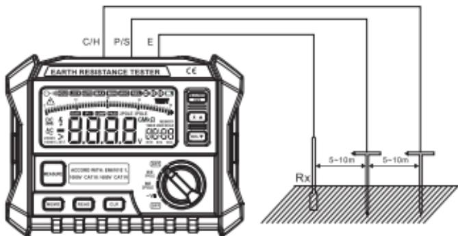
2. Установите вспомогательные заземляющие шины **P**, **C** вдоль прямой линии как можно глубже в землю таким образом, чтобы между ними было расстояние 5-10 метров. Подсоедините измерительные провода (черный, красный и зеленый) к гнездам **E**, **P**, **C**. Противоположные концы измерительных проводов соедините с измеряемым объектом, вспомогательной шиной **P** и вспомогательной шиной **C**.
